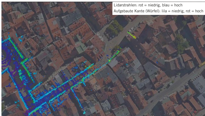
BILD 4 Automatisch erstellte Darstellung der Fahrzeugumgebung in Echtzeit auf einer Fahrt (daher reduzierte Auflösung); im Hintergrund zum Vergleich ein Satellitenbild (© Bertrandt)
