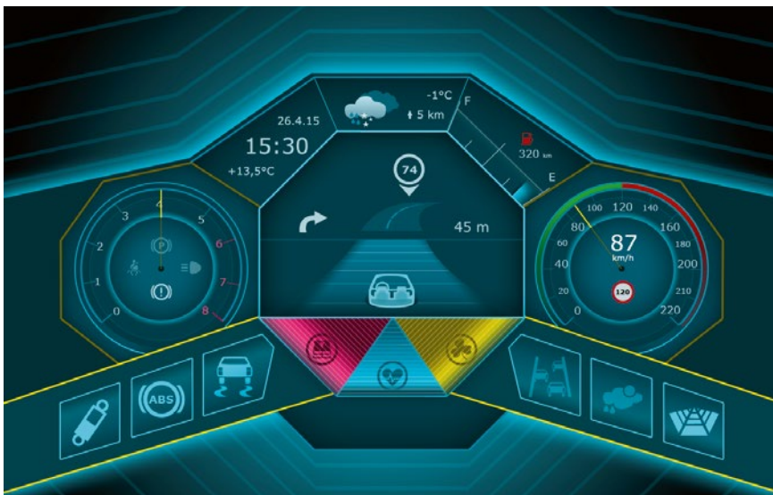
BILD 3 Beispielhafte Visualisierung des Fahrzeugzustands im Kombiinstrument inklusive aktueller Wetterdaten und der zukünftigen Aktionen, wie Kurven und Geschwindigkeitsbegrenzungen; hervorzuheben ist die Darstellung des erkannten Fahrstils in den Farben Magenta (Sicherheitsbewusstsein), Blau (Sportlichkeit) und Gelb (Energieeffizienz) (© Bertrandt)
