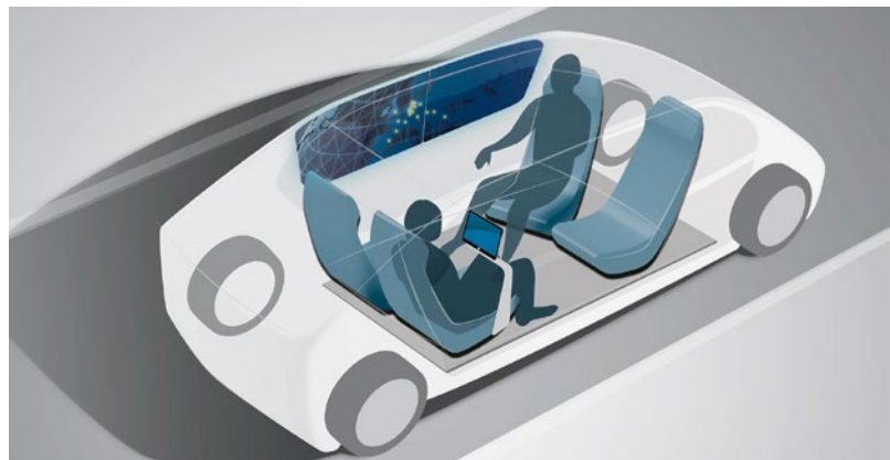
BILD 3 Der zukünftige Fahrzeuginnenraum bietet neue Möglichkeiten, Displays zu positionieren – auch Scheiben rücken als Anzeigemedium in den Mittelpunkt des Interieurs (© Bertrandt)
