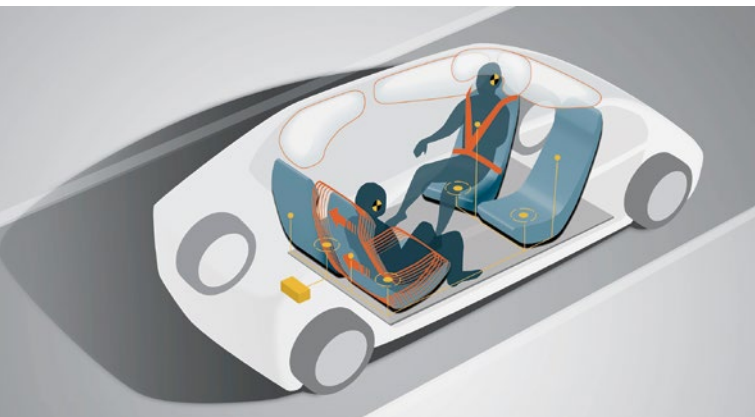
BILD 2 Das Sicherheitsniveau beim autonomen Fahren wird aus jetziger Sicht dem heutigen sehr ähnlich sein – der Schwerpunkt liegt voraussichtlich auf einem im Sitz integrierten Gurtsystem, Airbagsystemen sowie einer entsprechenden Sensorik (© Bertrandt)
