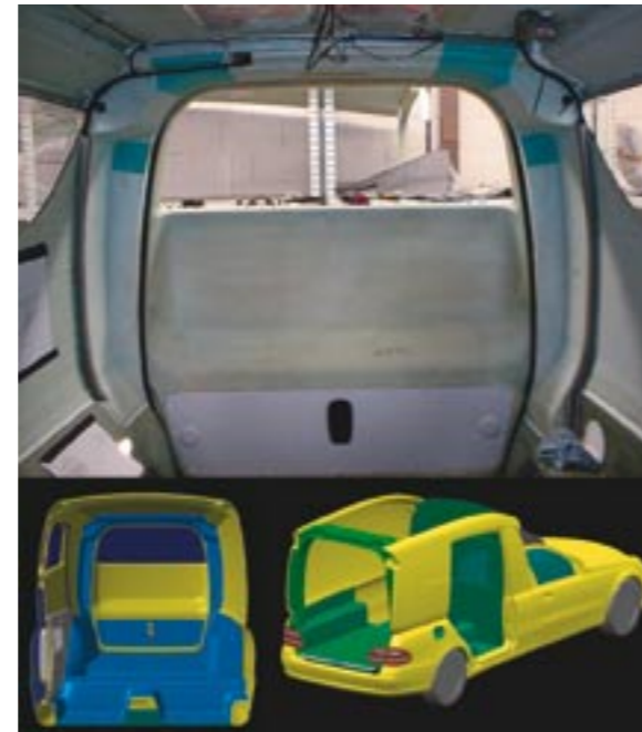
Komplexe Teile in Glasfaser-sandwich-Bauweise stellen Außen- und Innenflächen dar.
