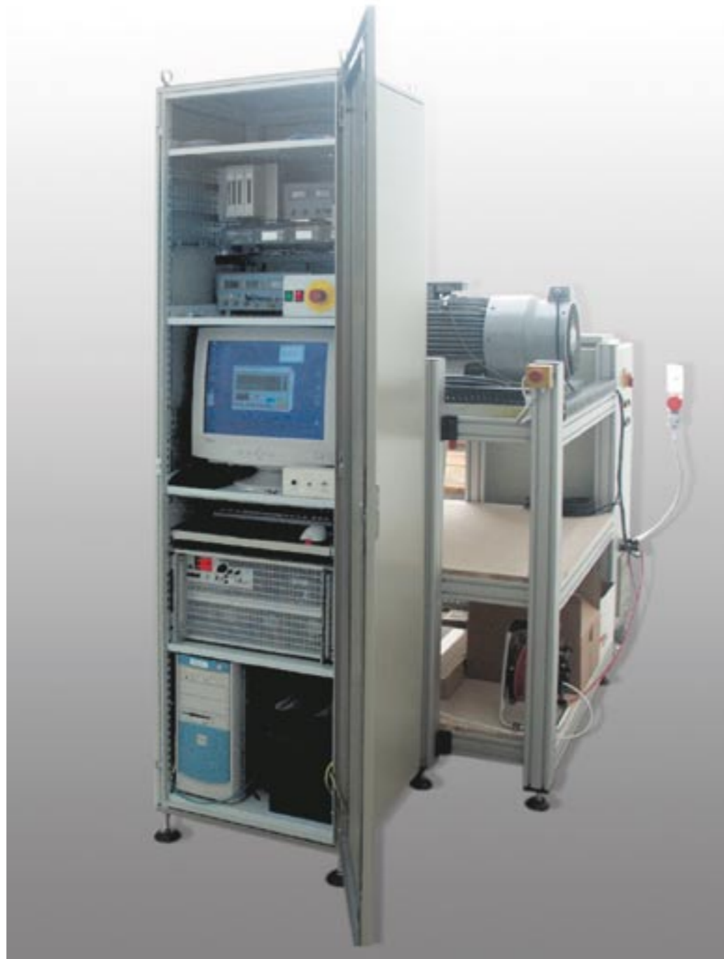
Bordnetzprüfstand zur Evaluierung von Systemfunktionen des Fahrzeug-Energienetzes.
