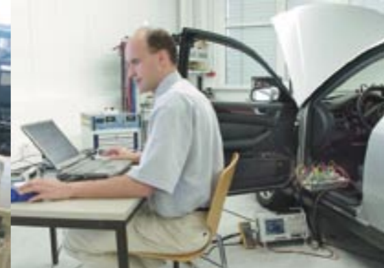
Systemtests im vernetzten Verbund (CAN, LIN, MOST) an einem Fahrzeugtechnikträger sowie am LabCar.
